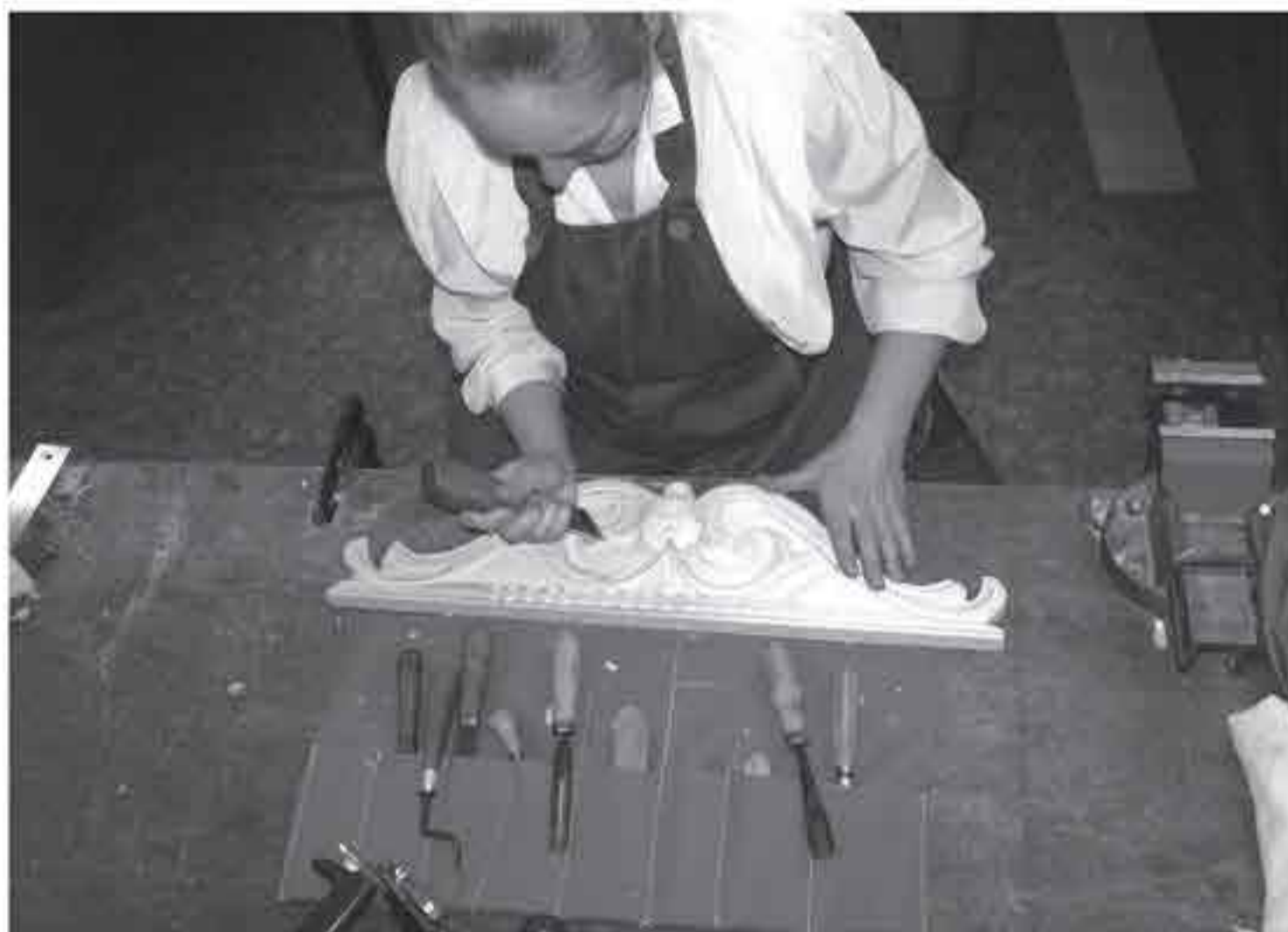
Рис. 3. Работа реставратора (В. А. Таушканова) как мастера-резчика с применением резничных инструментов по подобранному аналогу ко-кошника корпуса шкафа-буфета
